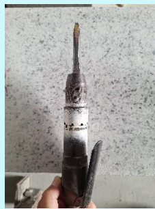
ニーマー 先端がエアールで振動します。 レバーで強さを調整できます。
